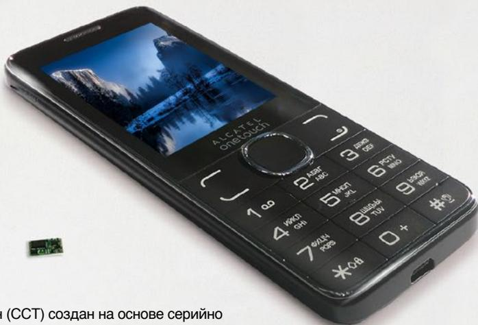
Специальный сотовый телефон (ССТ) создан на основе серийно выпускаемого мобильного телефонного аппарата стандарта GSM, защита обеспечивается встроенным криптомодулем безопасности, отсутствуют демаскирующие признаки.
